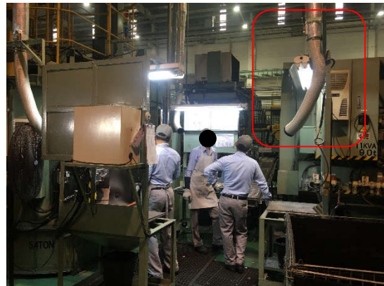
รูปถ่ายที่ 3.2-45 : พัดลมระบายความร้อน และเครื่องปรับอากาศ
